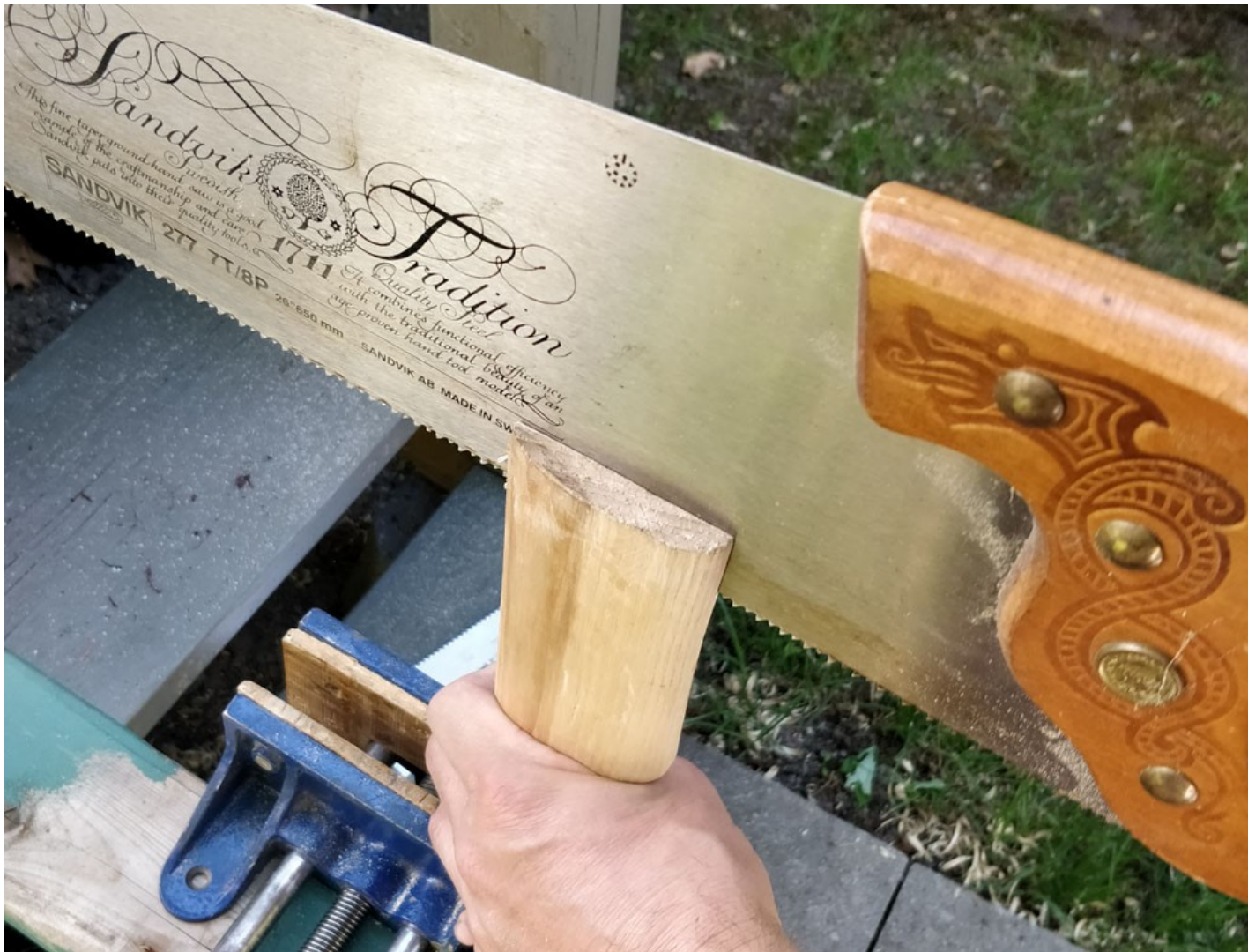
9) Donner deux couches de vernis au Varathane et laisser sécher 24hres entre les couches. Sabler doucement après la première couche. Voici une image prise après une couche de vernis et, en dessous, le vieux manche (en mauvais état...) qu'il est destiné à remplacer...
